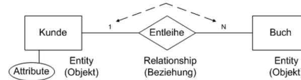
Graphisches Hilfsmittel zur semantischen Modellierung eines Anwendungsgebietes, d.h. zum Entwurf einer Datenbank, unabhängig vom konkreten DBS.
