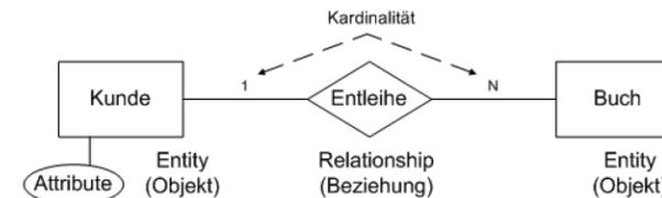
Graphisches Hilfsmittel zur semantischen Modellierung eines Anwendungsgebietes, d.h. zum Entwurf einer Datenbank, unabhängig vom konkreten DBS.
